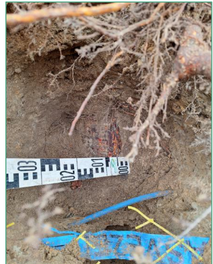
Afbeelding 6.1 Zware beworteling en kabels bij boom 111
