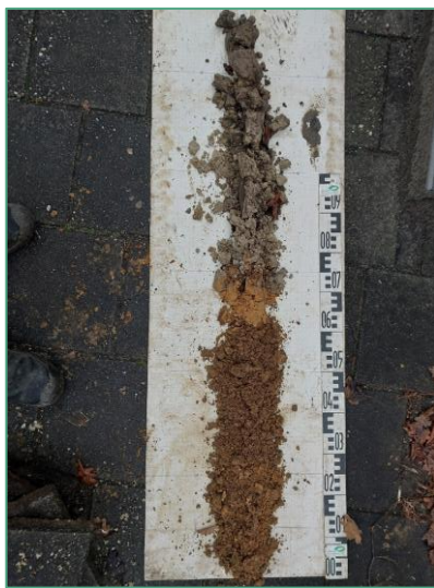
Foto 48 Aangetroffen bodemprofiel
