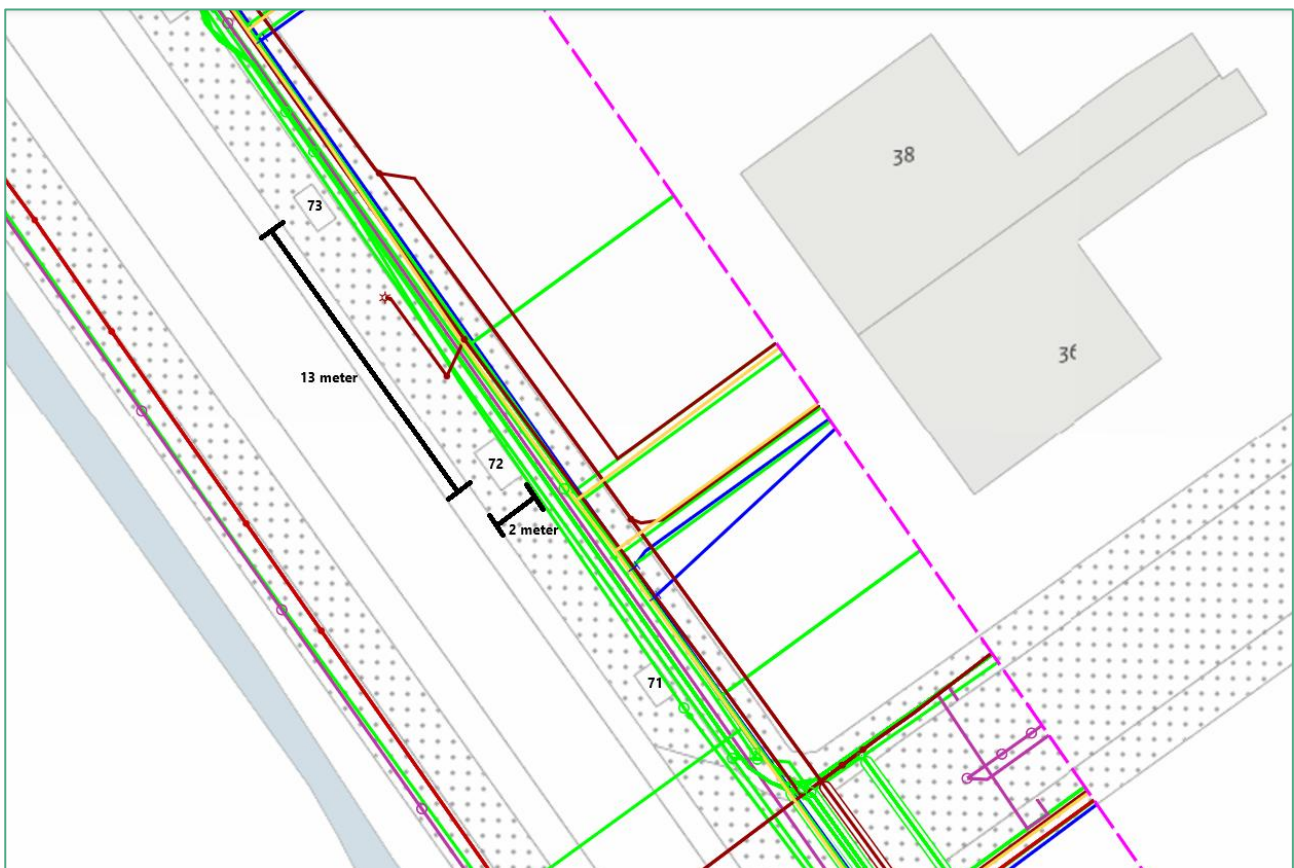
Afbeelding 5.2 Ondergrondse ruimte onder parkeervakken
