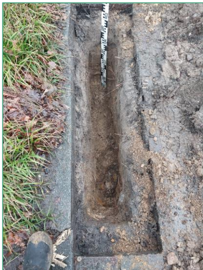
Foto 65 Diepte profielsleuf
