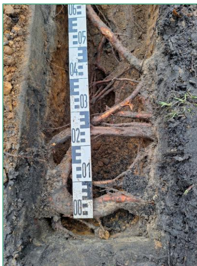
Foto 315 Diepte profielsleuf en aangetroffen beworteling
