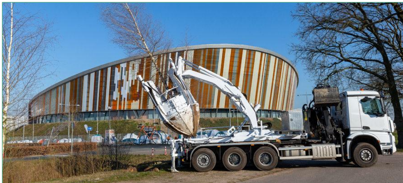
Afbeelding 6.3 Verplanting met de Optimal verplantmachine van idverde Bomendienst met een kluitdiameter van max. 1,9 meter.
